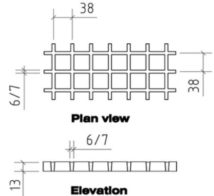
Auf Anfrage sind diese Gitterroste in verschiedenen Höhen, Farben, Paneelformaten und Maschenweiten lieferbar. Dieser Typ Gitterrost ist außerdem mit einer Meniskusoberfläche lieferbar.
