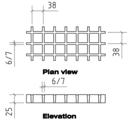
Gitterroste in dieser Höhe sind standardmäßig auch in 3660 x 1220 mm erhältlich. Außerdem sind unterschiedliche Panelabmessungen in den Höhen 13, 30, 38 en 50 mm erhältlich. Auch lieferbar in den Farben Grau und Gelb.
