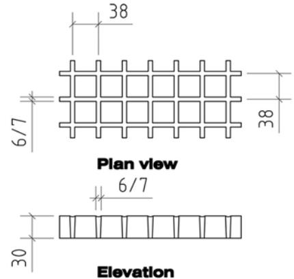
Gitterroste in dieser Höhe sind standardmäßig auch in 2000 x 1000 mm, 3000 x 1000 mm, 3048 x 915 mm und 3660 x 1220 mm erhältlich. Außerdem sind unterschiedliche Panelabmessungen in den Höhen 13, 25, 38 und 50 mm erhältlich. Auch lieferbar in der Farbe Grün.
