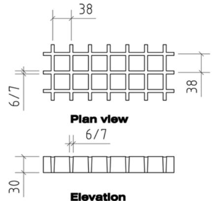
Gitterroste in dieser Höhe sind standardmäßig auch in 2000 x 1000 mm, 3000 x 1000 mm, 2440 x 1220 mm, en 3660 x 1220 mm erhältlich. Außerdem sind unterschiedliche Panelabmessungen in den Höhen 13, 25, 38 en 50 mm erhältlich. Auch lieferbar in den Farbe Grün.
